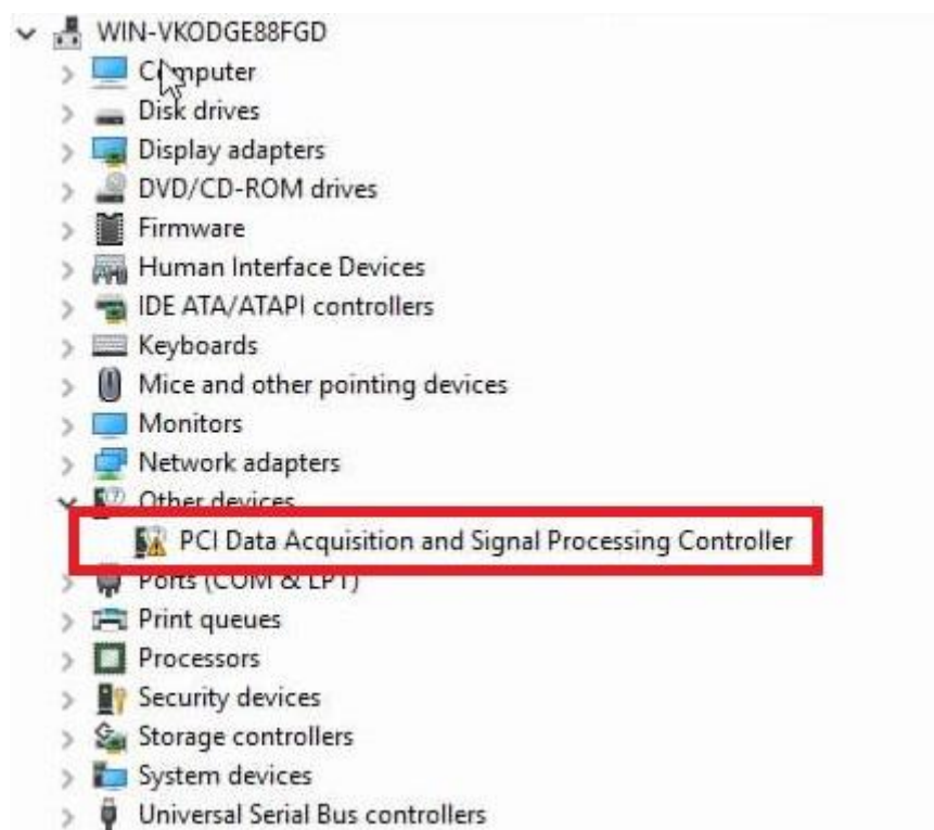
Рис. 9-1 Неизвестное устройство в ОС Windows сервера V5
