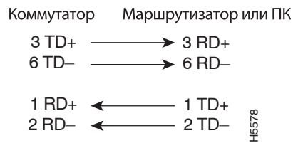
Рисунок 1-11 Схема прямого кабеля с двумя витыми парами
